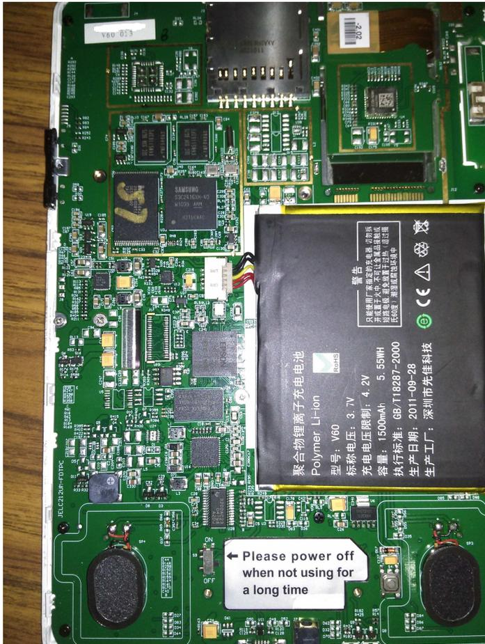
Esa es nuestra placa base. Ahora, para que se reinicie nuestra placa, tenemos que desconectar con mucho cuidado la batería. El conector de la batería es el que está en la siguiente imagen de color rojo. Sacamos el conector siguiendo la dirección de la flechita de color verde en la imagen:
